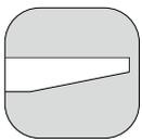
Plattenstärke 27 mm, sichtbar 12 mm,
