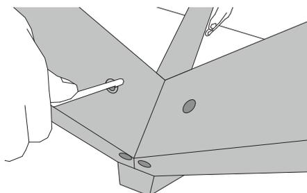
**3.** Wenn alle Tischbeine mit den Längszargen verschraubt sind, können zuerst die Madenschrauben der Tischbeine und am Schluss die Madenschrauben der abgewinkelten XS Verbinder in den Zargen fest angezogen werden.
