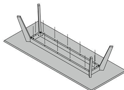
**4.** Das Gestell nun mit den Zylinderkopfschrauben und Beilagscheiben an die Tischplatte schrauben.
