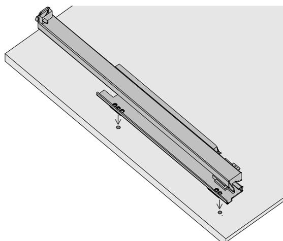
**1.** Schubführungen mit den beigelegten Schrauben auf den bereits fixierten KIN Shelf schrauben. Dabei darauf achten, dass die Schubführung in der hintersten Position angeschraubt wird. Die Seite mit dem größeren Randabstand der Bohrungen ist die Seite, an der die Türen am Korpus angeschlagen sind.
