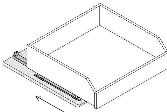
**2.** Die Führung ganz nach Vorne ziehen, die Schublade auf die Führungen setzen und wieder bis zum Anschlag nach hinten schieben bis die Mechanik hörbar in den orangenen Aufnahmekästen einrastet.
