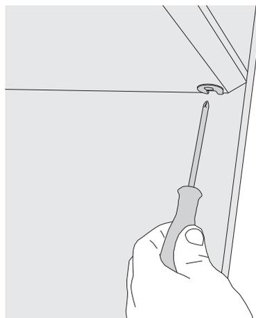
**2.** Anschließend mit Schraubendreher Kreuzschlitz (Gr.2) um eine halbe Umdrehung anziehen ( Tipp: dabei Schraubendreher leicht schräg halten).
