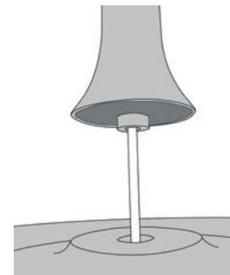
**3.** Darauf achten, dass der Zapfen in die Bohrung greift und das Haftgitter plan aufliegt.
