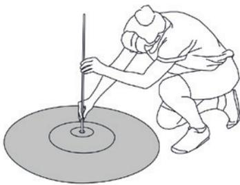
**1.** Die Tischplatte mit der Oberseite auf eine Decke o.ä. legen und die Gewindestange eindrehen.
