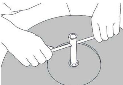
**7.** Mutter mit Steckschlüssel/ Ratsche **leicht** anziehen.
