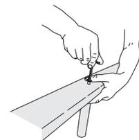
**6.** Einen geeigneten Mittelfuß auswählen und mit der Senkkopfschraube (M8x50) am Mittelsteg montieren. Ca. 1-2 cm niedriger als die übrigen FüÙe einstellen.
