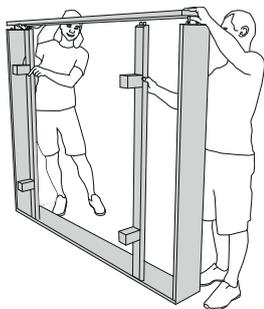
**4.** Zweite Längsseite aufstecken und mit Verbindern fixieren.
