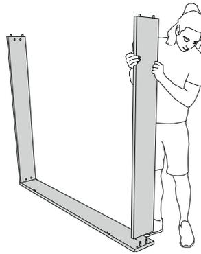
**2.** Kopf- und Fußteil aufstecken und mit Madenschrauben fixieren.
