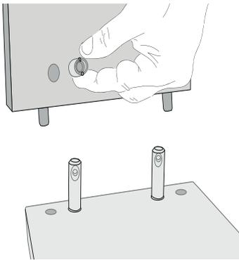
**1.** Bolzen in die Längsseiten eindrehen und Verbindergehäuse in Kopf- und Fußteil einstecken. Bolzen und Gehäuse richtig ausrichten!
