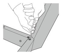
**2.** Die Zargen auf der Ober- und Unterseite mit den jeweils zwei Gehäusen bestücken, die Tischbeine mit den vier geraden XS Bolzen darauf stecken und die Verbindung mit den Madenschrauben oben und unten leicht verschrauben.
