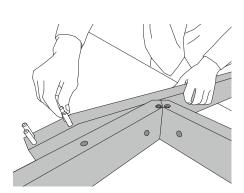
1. Nun die Tischbeine mit jeweils 4 geraden XS Bolzen bestücken. Diese bis zum Anschlag eindrehen und anschließend eine viertel bis halbe Umdrehung zurückdrehen, sodass die Kerben vertikal ausgerichtet sind.
