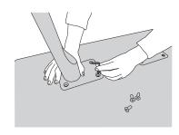
**3.** Alle vier Schrauben mit dem Innensechskantschlüssel eindrehen und fest anziehen.
