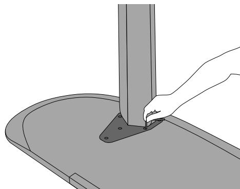
1. Die Montageplatte mit den Senkkopfschrauben M10 auf das Bein schrauben.
