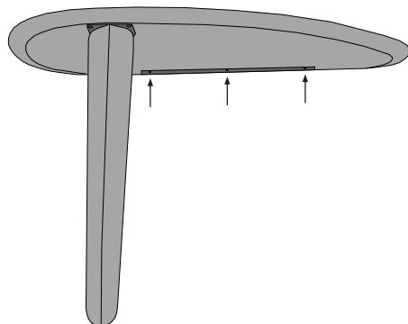
3. Den Montagewinkel an der Wand befestigen. Dafür je nach Wandbeschaffenheit die geeigneten Dübel und Schrauben verwenden.
