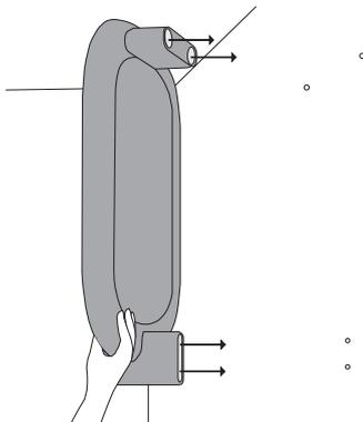
3. Den Wandspiegel mit den Schlüssellochbeschlägen auf die Schraubenköpfe setzen. Die Schrauben bei Bedarf nachjustieren.
