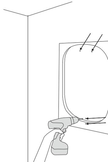
2. Die Weichfaserplatte als Bohrschablone verwenden. Die Schablone mit der Wasserwaage an der Wand ausrichten. Die 4 Löcher markieren und entsprechend in die Wand bohren. Je nach Wandbeschaffenheit die entsprechenden Dübel verwenden. Dübel setzen und die Schrauben eindrehen, bis nur noch ca. 7 mm der Schrauben herausstehen.
