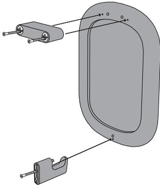
1. Den Montageblock und den Haken mit Confirmatschrauben anschrauben.
